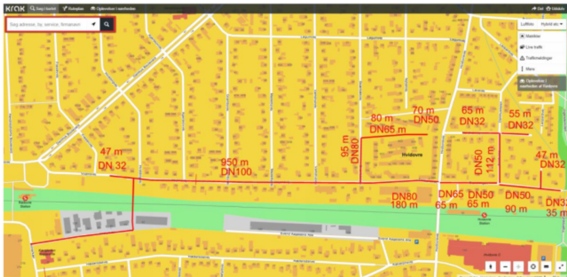
Figur 2 Oversigt over det planlagte forsyningsnet ved Vojensvej
