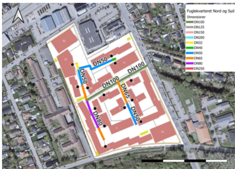
Figur 2: Den planlagte ledningsføring for det nye boligområde ved Tårnfalkevej.
